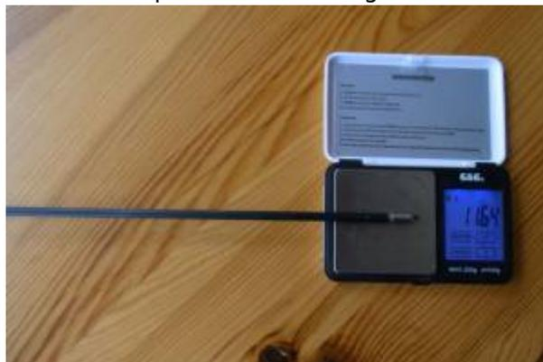
Aus der Gewichtsunterschied wird der FOC und der Schwerpunkt ermittelt. Ganz unten links muss die Pfeillänge in mm eingegeben werden da sonst keine Berechnung möglich ist. Im Idealfall liegt die Gewichtsunterschied bei 1 Grain  $\sim 0,06g$  angeblich ist dies der Bereich den Spitzenschützen anstreben.
