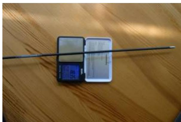
Das Gewicht auf der Seite der Spitze ermittelt man in dem der Pfeil mit der Nocke auf eine Unterlage in Höhe der Waage gelegt wird und die Spitze auf die Waage selbst.
