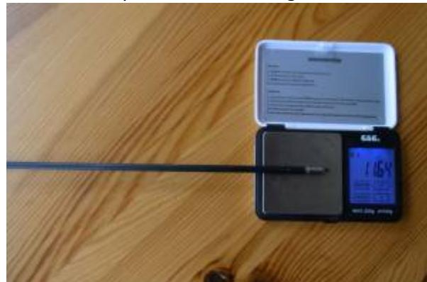
Aus der Gewichtsdifferenz wird der FOC und der Schwerpunkt ermittelt. Ganz unten links muss die Pfeillänge in mm eingegeben werden da sonst keine Berechnung möglich ist. Im Idealfall liegt die Gewichtsdifferenz bei 1 Grain ~ 0,06g angeblich ist dies der Bereich den Spitzenschützen anstreben.
